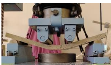
“しなる”コンクリート
